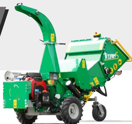
**TITANS W** est une déchiqueteuse de déchets verts sur roues automotrice. Efficace, son système d'alimentation fonctionne à l'aide d'un imposant rouleau denté, ainsi que du système de régulation "No stress". L'entraînement hydrostatique des roues nécessite peu d'entretien. L'ouverture complète de la chambre de broyage facilite l'entretien des éléments de coupe. Le système de broyage et d'éjection sont spécialement conçus afin d'éviter le colmatage du broyat et le bourrage de la déchiqueteuse.
