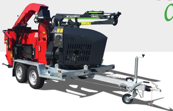
**Greentec 30R** est un broyeur forestier sur châssis routier de moins de 3.5t et de diamètre admissible 30cm. 2 rouleaux d'alimentation verticaux, alternant crampons et lames, tirent les branches jusqu'à l'imposant volant de coupe de 960mm de diamètre. Le disque incliné à 50° nécessite moins de puissance afin de broyer les végétaux. Il est équipé de grandes pales qui éjectent facilement le broyat à travers une goulotte entièrement ajustable, à plus 5 mètres de hauteur.
