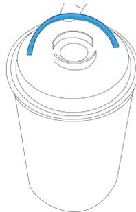
Figure 72 - Languette de levage
