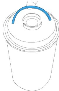
Figure 76 - Languette de levage
